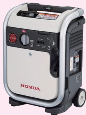
交流定格出力：100V-900VA、連続運転時間：約2.2~1.1時間、使用燃料：カセットガス2本体サイズ：W365mm×D262mm×H524mm（ハンドル折りたたみ状態）、重量：19.5kg
