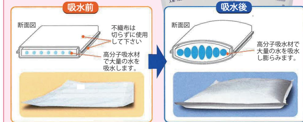
※吸水材として使用、油、溶剤、海水等の吸水は出来ません。※吸水後の再利用は出来ません。使用後は3日程度天日干し、もしくは脱水剤を使用しての排水後、地域の規則に従って破棄して下さい。
