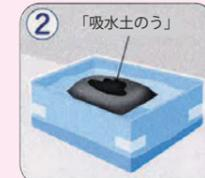
② 「吸水土のう」 「吸水土のう」を1枚ずつ浸して高さ10cm以上になるまで膨らませて下さい。水道水以外の海水、油では膨らみません。
