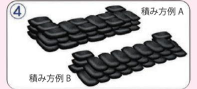
④ 積み重ねることによって止水効果が高まります。積み上げは最大3段（約30cm）、水位は20cm以下で使用して下さい。
